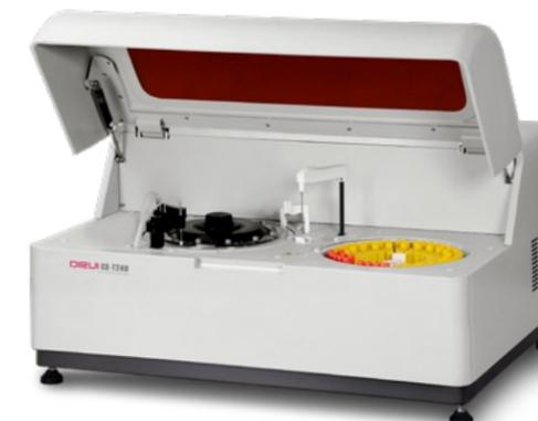
El analizador de autoquímica CS-T240 es un analizador de química clínica de acceso aleatorio, que puede adaptarse a cualquier tipo de laboratorio para análisis de rutina y de emergencia. El rendimiento es de 240 Muestras/hora con hasta 57 elementos de prueba realizados simultáneamente. Es conveniente, flexible, económico para laboratorios de nivel bajo y medio.
